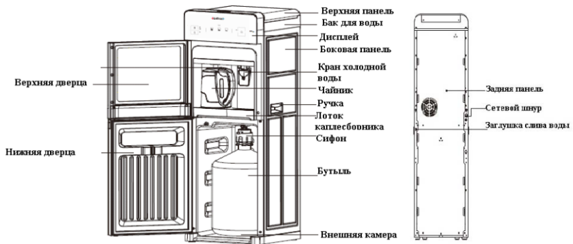
Рис.1. Схема аппарата 350 ANET gold
