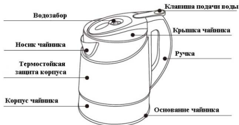
Рис.2. Схема чайника 350 ANET gold
